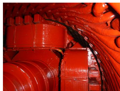
発電機（4極界磁・2,050kW）
